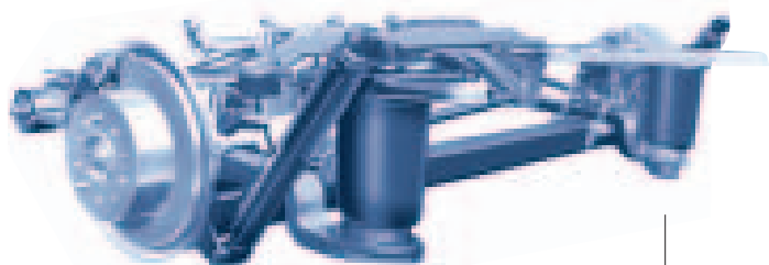
Díky polohovacímu zavěšení má vozidlo konstantní světlou výšku za každé situace bez ohledu na zatížení a rozmístění nákladu (na objednávku).
